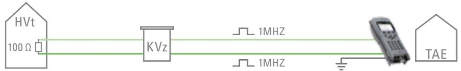
Bei der LCL-Messung (Unsymmetriedämpfung) wird die Balance zwischen der a-Ader zur Erde im Vergleich der b-Ader zur Erde betrachtet. Kann zwischen den Adern eine Differenz gemessen werden, liegt eine Unsymmetrie (Werte < 40 dB) vor.
